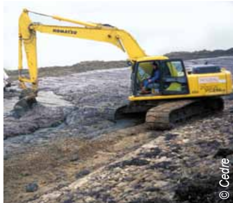
استخدام الحفارات الهيدروليكية في إزالة التلوث النفطي اللزج
