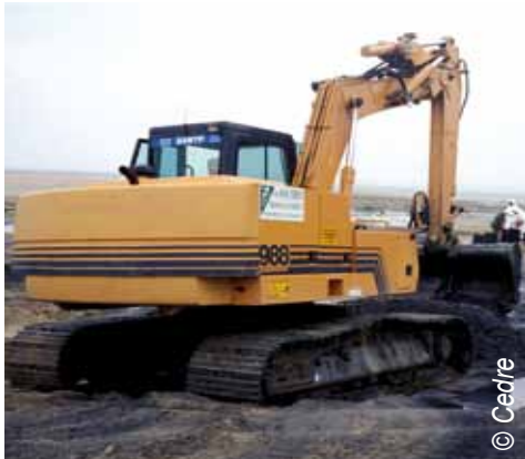
استخدام الحفارات الهيدروليكية في إزالة التلوث النفطي اللزج
